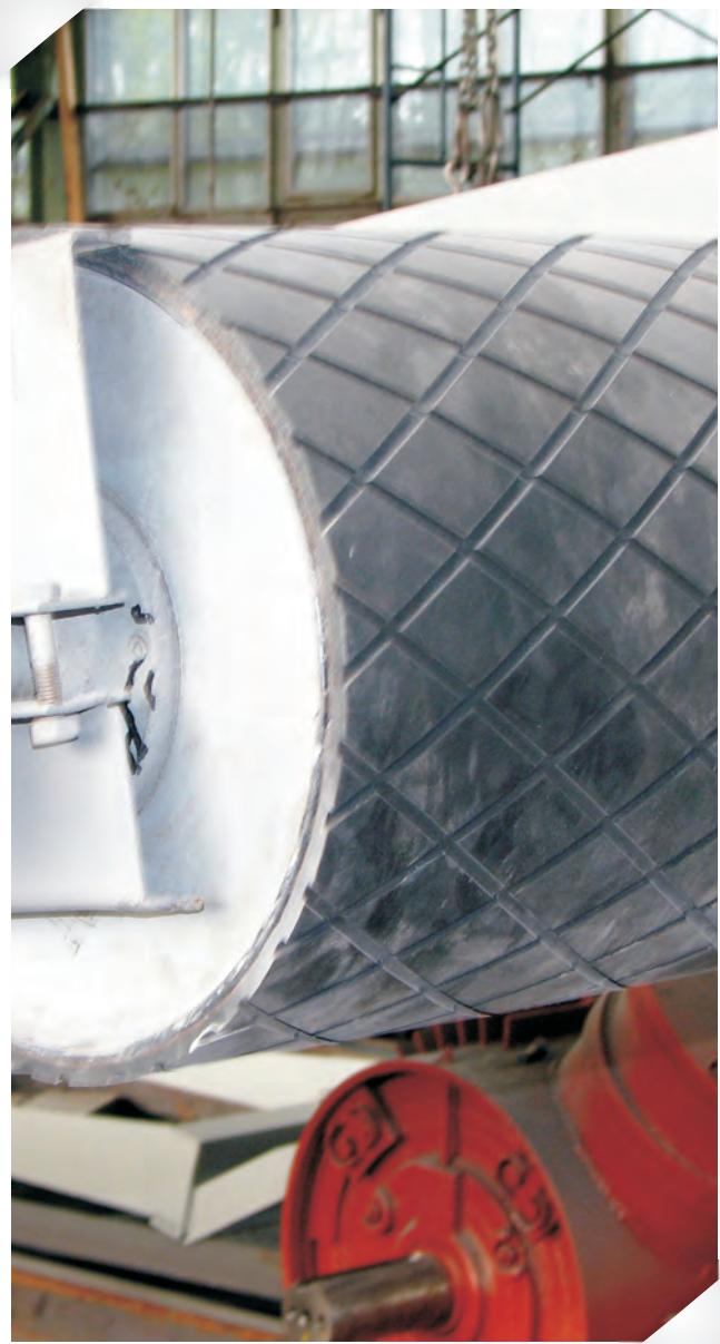
Se pot încărca cu diferite tipuri de cauciuc în gama de duritate 55-90 SH-ore, cu diferite destinații:
